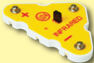
Infrared module (U24)
