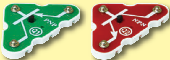
PNP & NPN Transistors (Q1 & Q2)
